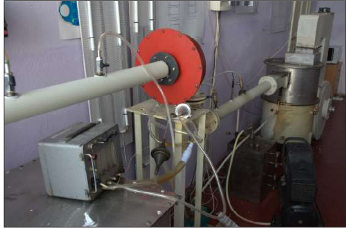
Рис. 3. Експериментальний стенд для дослідження ефективності сепараторів стиснутих газів
