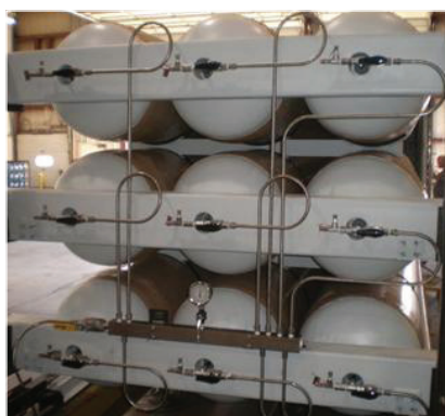
Рис. 1. Модуль для транспортування стиснутого природного газу, укомплектований балонами типу CNG-2
