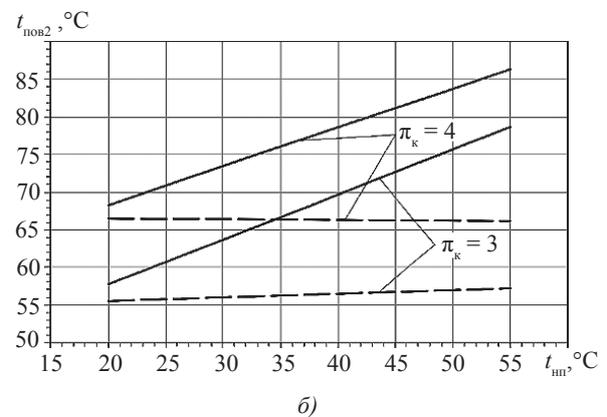
**Рис. 3.** Зависимости повышения давления в термопрессоре  $\Delta P$  (а) и температуры воздуха на выходе из термопрессора  $t_{\text{нов2}}$  (б) от температуры внешнего воздуха  $t_{\text{вн}}$ :
