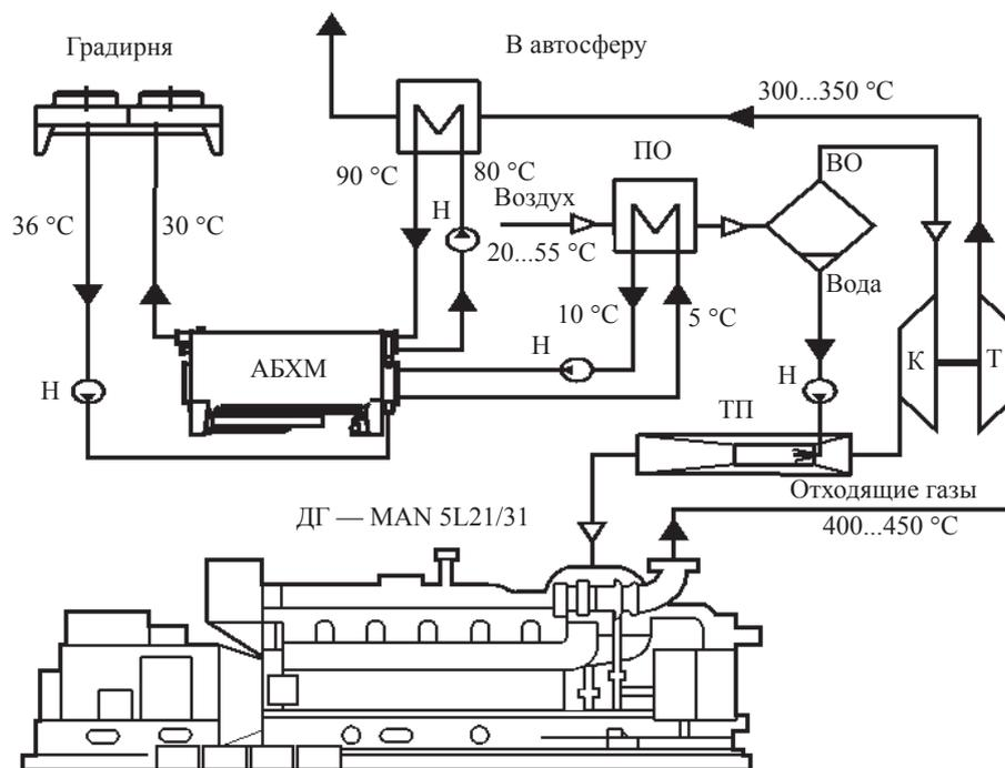
Рис. 1. Схема термопрессорной системы охлаждения наддувочного воздуха ДВС:
