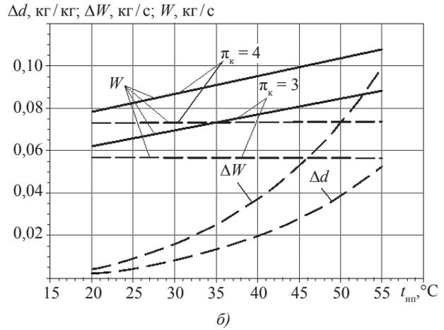
**Рис. 2.** Зависимости коэффициента влаговыпадения  $\xi$  (а), уменьшения влагосодержания  $\Delta d$ , количества сконденсированной в ПО влаги  $\Delta W$ , расхода воды на впрыск в термопрессоре  $W$  (б) от температуры внешнего воздуха  $t_{\text{вн}}$ :
