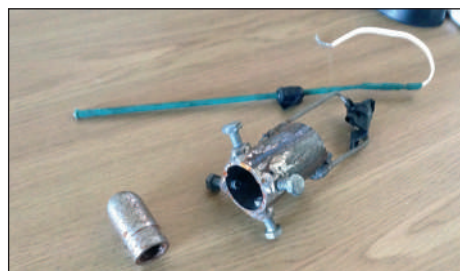
Рис. 10. Експериментальна модель для випробувань водометного рушія на ефекті електрогідродудару в розібраному стані
