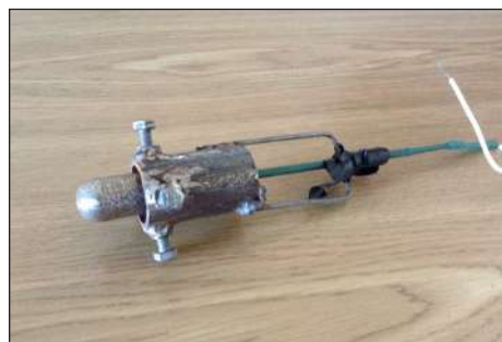
Рис. 11. Експериментальна модель для випробувань водометного рушія на ефекті електрогідродудару
