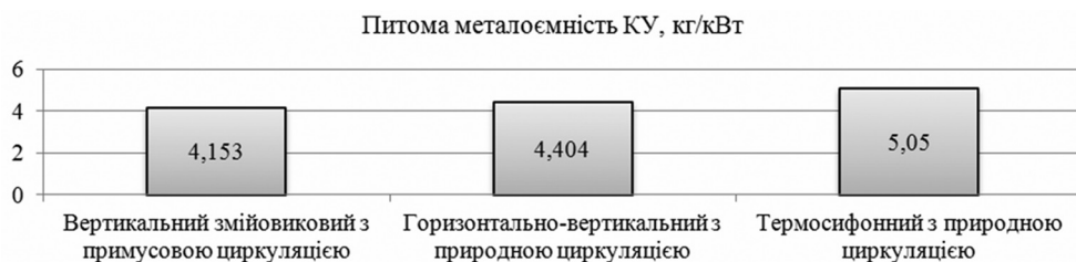
Рис. 4. Порівняння металоємності для різних типів котлів-утилізаторів
