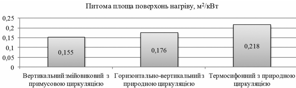
Рис. 3. Порівняння питомої площі поверхонь нагріву для різних типів котлів-утилізаторів
