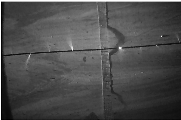
Рис. 4. Стримеры на электроде-струне в состоянии покоя
