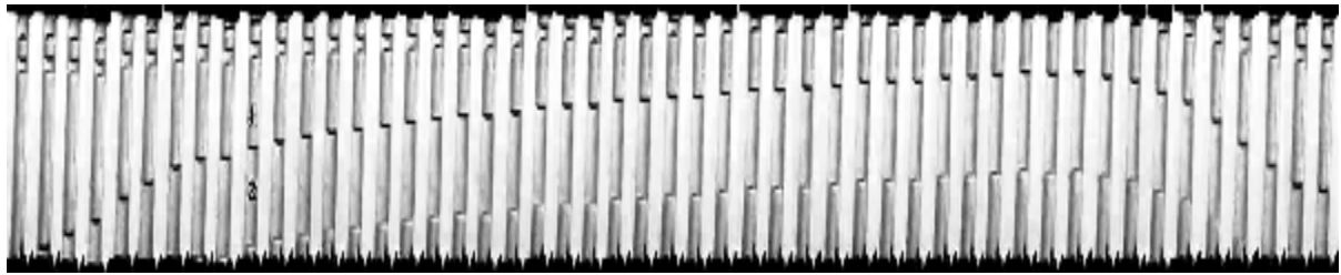
Рис. 4. «Пружинящее» действие паровых снарядов: 1 – пар; 2 – жидкость
