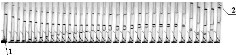
Рис. 6. Сдавливание парового снаряда: 1 – пар; 2 – жидкость
