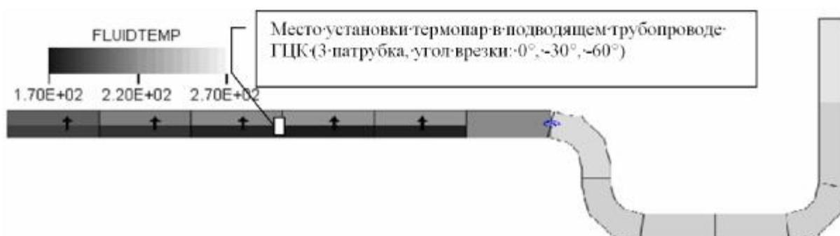
Рис. 5. Распределение температуры теплоносителя в подводящем трубопроводе ГЦК
