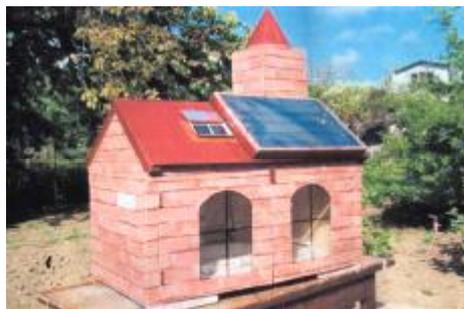
Модель бака-аккумулятора – пластмассовый теплоизолированный куб объемом  $0,002 \text{ м}^3$ , расположенный выше верхней панели. Все элементы установки вмонтированы в модель «Солнечного дома», которая разработана и создана на кафедре «Энергосбережения и нетрадиционных источников энергии» СНУЯЭиП (рис. 3).
