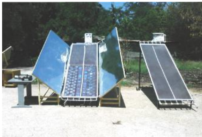
Рис. 2. Теплова (справа) та теплофотоелектрична з концентратором (зліва) сонячні установки
