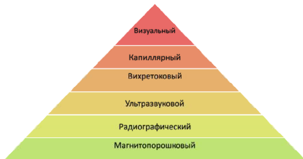
Рис. 5. Наиболее распространенные методы контроля основного оборудования на АЭС
