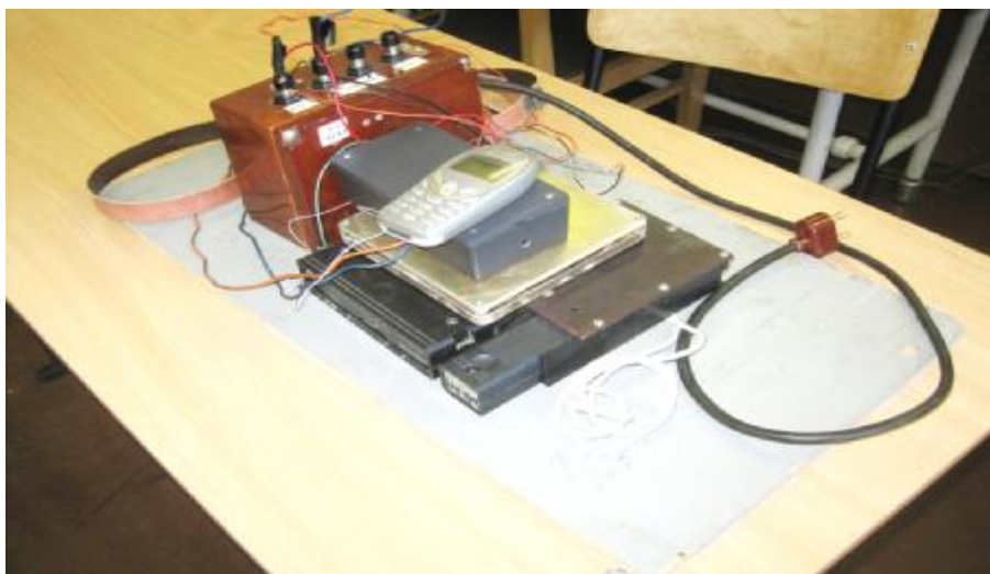
Рис. 1. Действующий макет устройства для осуществления внешнего дистанционного контроля с использованием возможностей сотовой телефонной связи
