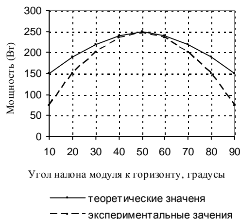
Рис. 7. Зависимость изменения выходной мощности фотоэлектрического модуля RS 250 при изменении угла наклона модуля к горизонту
