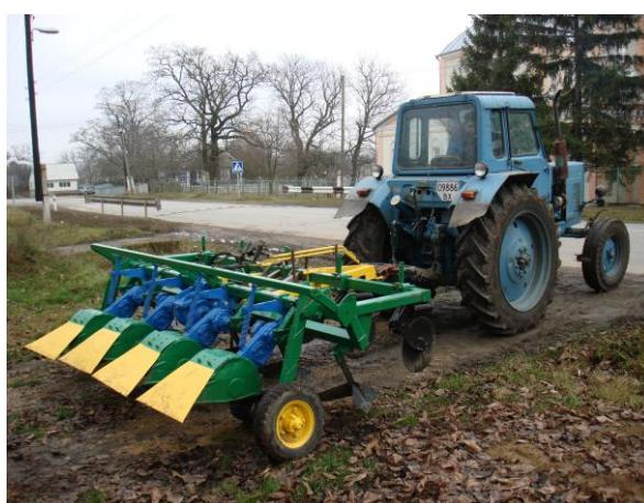
*Рис. 3. Подрібнювач КФП – 2,8 в транспортному положенні*
