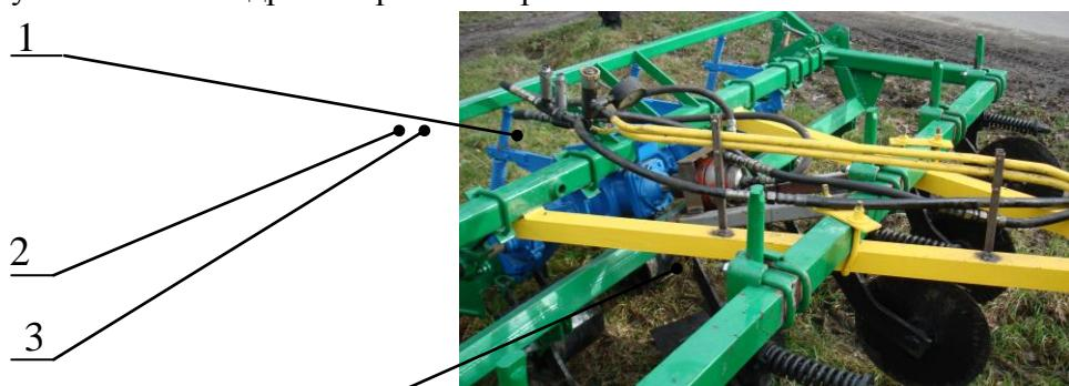
*Рис. 2. Елементи гідроприводу подрібнювача*
