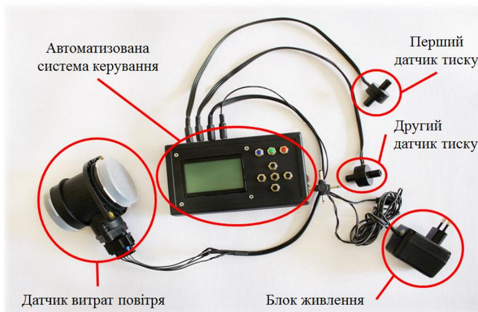
Рис. 8. Макетний зразок комплекту устаткування контролю вакуумметричних параметрів доїльного обладнання.
