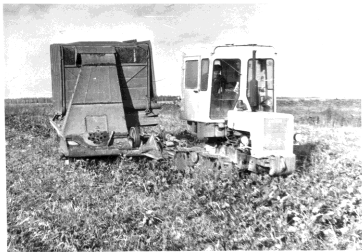
Рис.2. Використання косарки-подрібнювача КІР-1,5Б на збиранні гички кормових буряків
