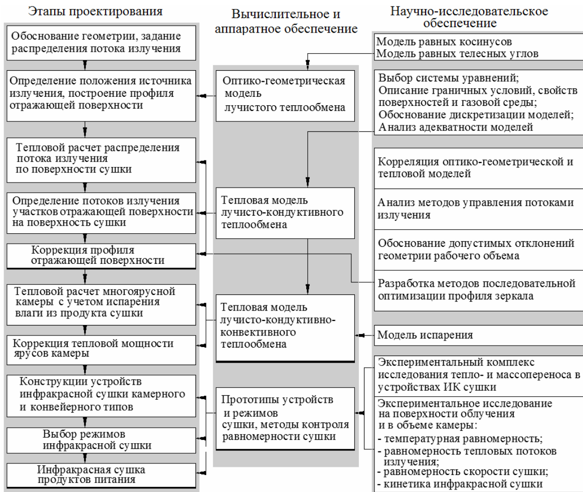
Рис. 2. Метод проектирования устройств инфракрасной сушки
