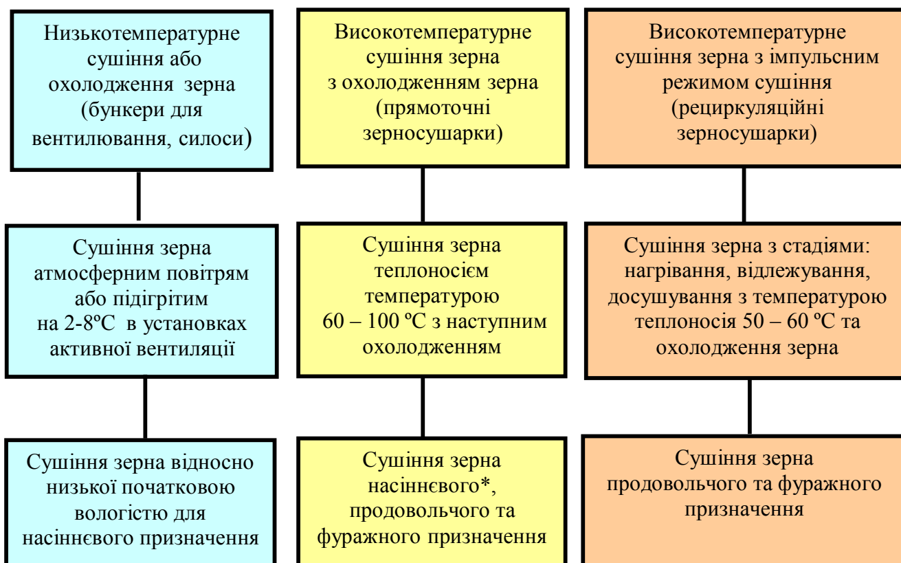
Рис. 1. Класифікація способів конвективного сушіння зерна
