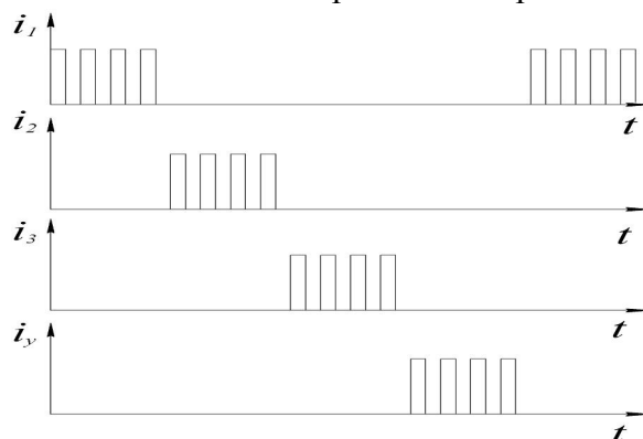
Рис. 3. Еп'юри струмів електромагнітів варіативного нахилу днища та струмів електромагнітного вібробуджувача
