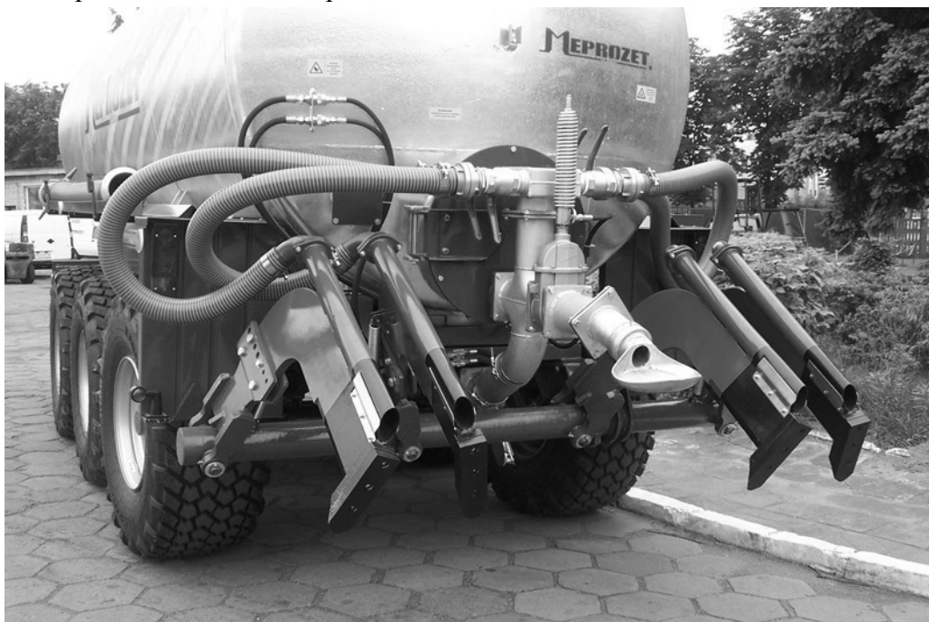
Рис. 3. Цистерна із встановленими робочими органами для внесення рідкого гною [6]
