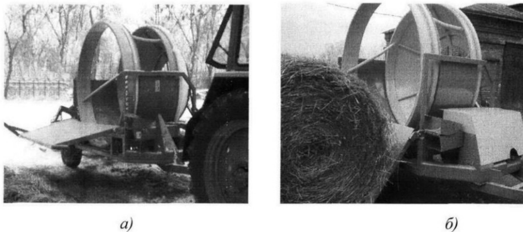
Рис. 2. Загальний вигляд подрібнювача-роздавача (а), подрібнювач-роздавач з відкритим гідробортом (б)
