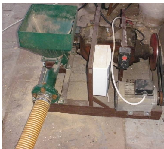
Рис. 2. Загальний вигляд стенду для дослідження процесу транспортування матеріалів гвинтовим механічним та шинково-пневматичним транспортером
