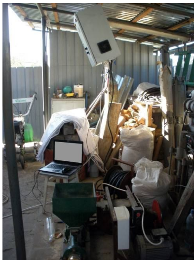
Рис. 2. Загальний вигляд стенду для дослідження процесу транспортування матеріалів гвинтовим механічним та шинково-пневматичним транспортером
