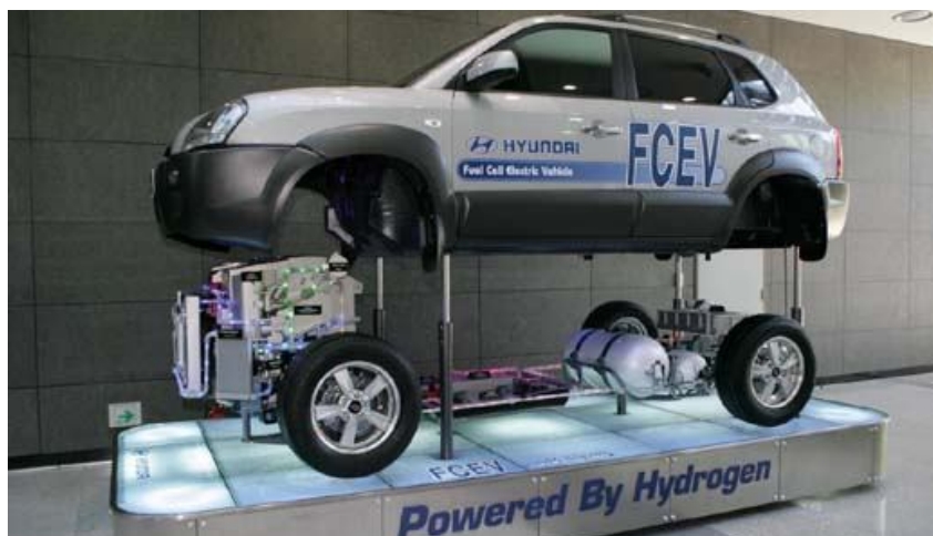
Рис. 1. Переобладнання класичної компоновки автомобіля водневим двигуном
