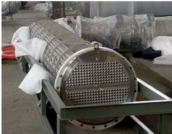
Рис. 9. Загальний вигляд кожухотрубного теплоутилізатора
