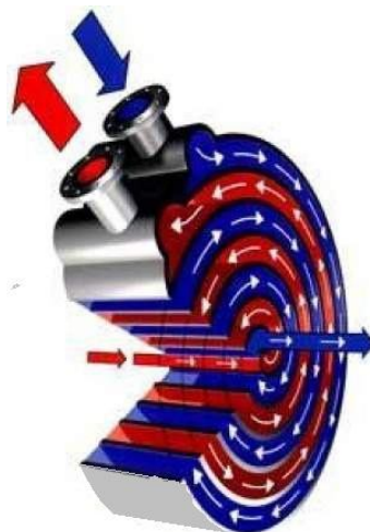
Рис. 7. Загальний вигляд спіральних теплоутилізаторів
