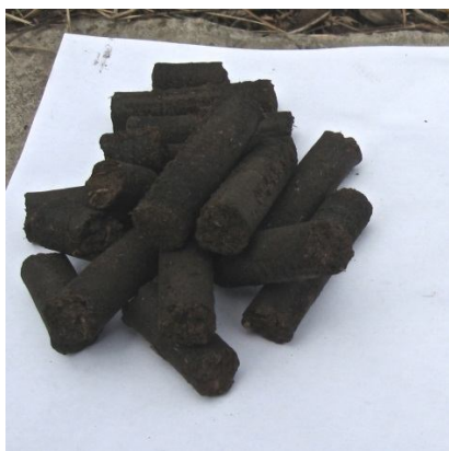
Рис. 6. а) готовые гранулы; б) исходное сырье - кора хвойных пород древесины
