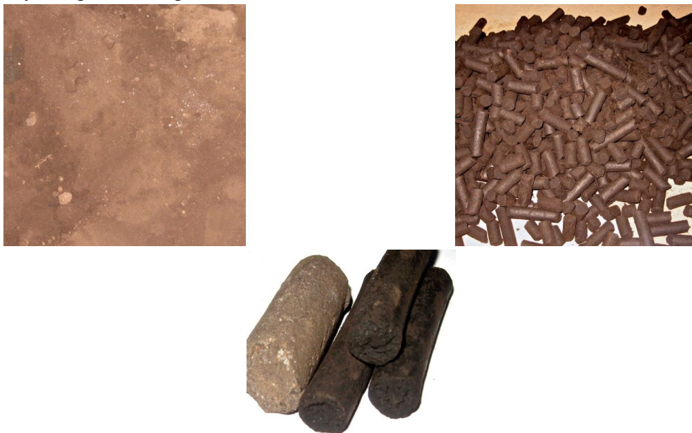
Рис. 2. а) исходное сырье – гидролизный лигнин; б) готовые гранулы; в) готовые гранулы (крупный масштаб)
