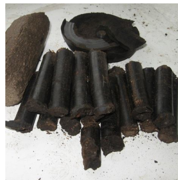
Рис. 5. Гранулы из растительных отходов, образующихся при уборке подсолнечника
