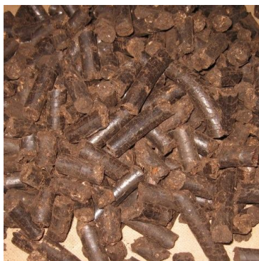
Рис. 5. Гранулы из растительных отходов, образующихся при уборке подсолнечника
