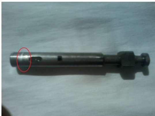
Рис. 7. Пошкодження робочої поверхні плунжера
