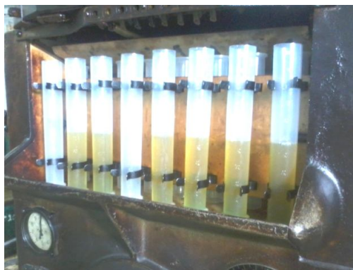
Рис. 4. Вимірювання циклової подачі біопалива на стенді КИ-921-М
