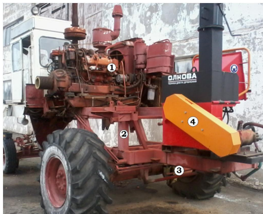
Рис. 1. Загальний вигляд приводної деревоподрібнювальної установки: 1 – двигун СМД-64, 2 – шасі КС-6Б, 3 – гідромотор МП-90; 4 – деревоподрібнювальна машина «Олнова» ДР-660Е
