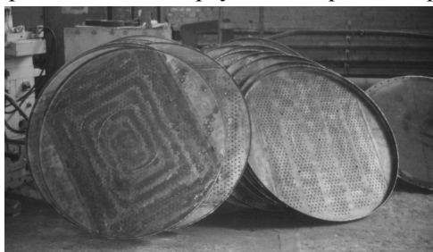
Рис. 8. Вироби, отримані ротаційним відбортуванням круглих листових заготовок
