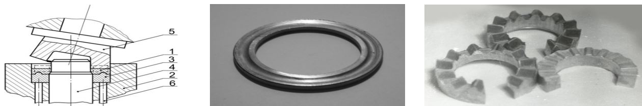
Рис. 8. Схема прямого витискування-калібрування і вигляд отриманих заготовок: 1 - заготовка, 2 - обойма, 3 - матриця, 4 - оправка, 5 - валок, 6-виштовхувач
