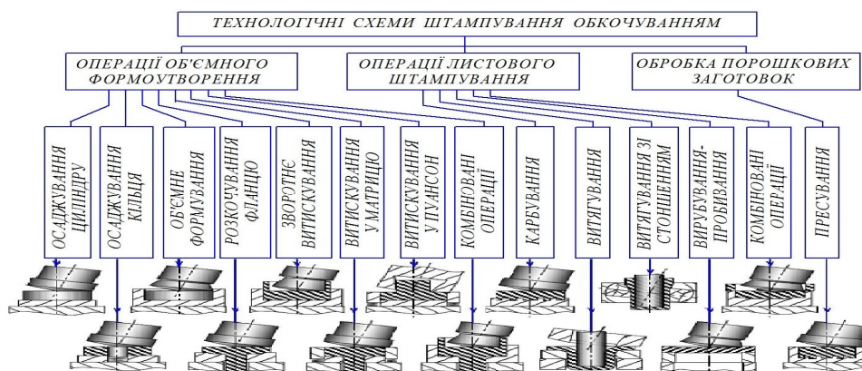
Рис. 3. Технологічні схеми штампування обкочуванням
