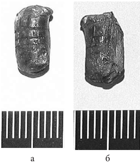
Рис. 8. 5,6 мм свинцева куля під кутом зустрічі з поверхнею бетонного блока, наближеним до 0^\circ (а — один бік кулі; б — зворотний бік кулі зі слідами рикошету)
