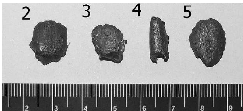
Рис. 11. Фрагменти 5,6 мм куль після рикошету (один бік)
