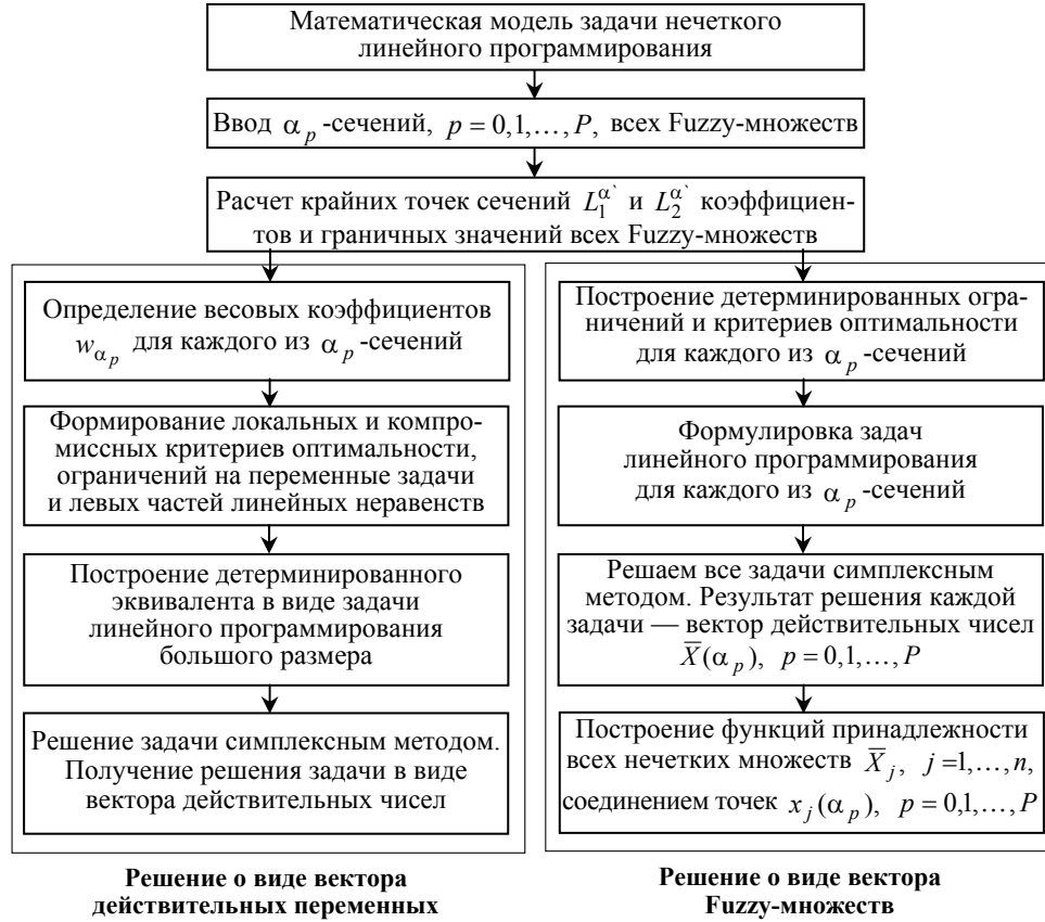
Рис. 3. Общая схема методов построения алгоритмов нечёткого математического программирования
