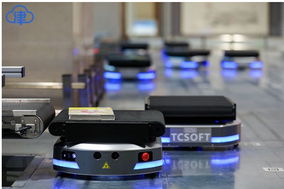
Рис. 7.53. Взаємодія роботів-обробників (транспортер ліворуч) і роботів-сортувальників (праворуч) у Бібліотеці китайсько-сінгапурської дружби в м. Тяньцзінь (КНР)
