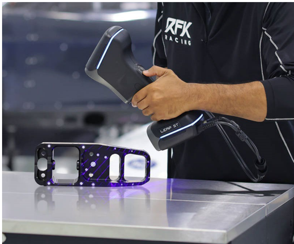
Рис. 7.33. Високоточний ручний 3D-сканер із п'ятьма режимами вимірювання FARO Leap ST Handheld 3D Scanner 119
