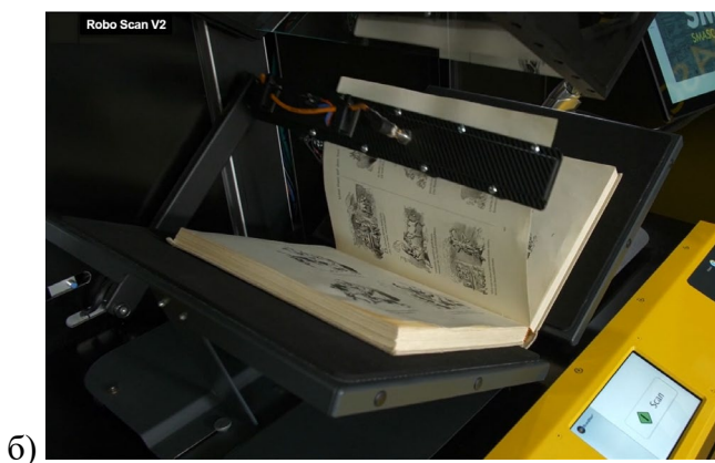
Рис. 7.17. Роботизований книжковими сканер SMA ROBO SCAN V2: а) схематичне позначення руху роботизованих механічних складових (модифікація без панелі керування); б) перегортання сторінки рукою-маніпулятором (модифікація з панеллю керування, на рисунку жовтого кольору) 88
