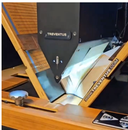
Рис. 7.20. Сканування розвороту розкритої книги на 60° і автоматичне перегортання сторінки за один прохід призми фірми TREVENTUS: а) процес в цілому; б) стан скануючого елемента призми під час її застосування
