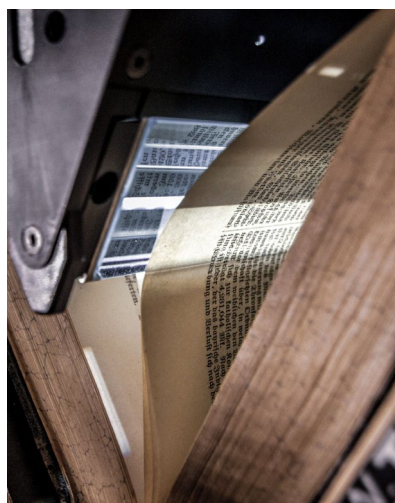
Рис. 7.20. Сканування розвороту розкритої книги на 60° і автоматичне перегортання сторінки за один прохід призми фірми TREVENTUS: а) процес в цілому; б) стан скануючого елемента призми під час її застосування
