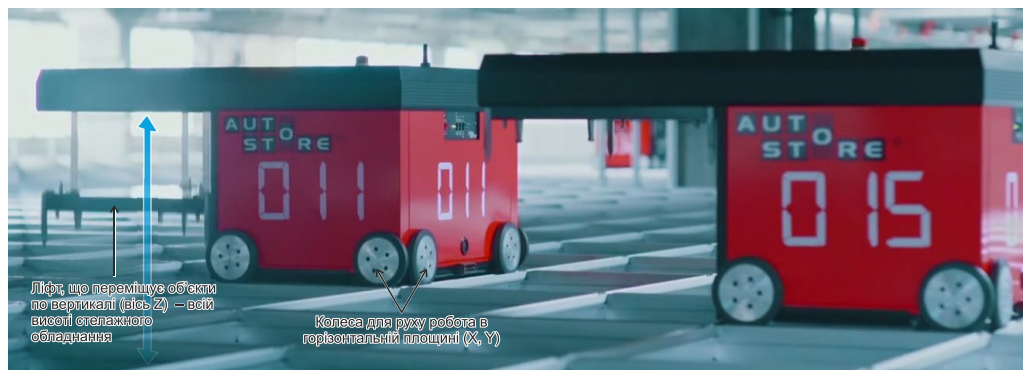
Рис. 7.4. Візки для AutoStore robotic cube technology Kardex
