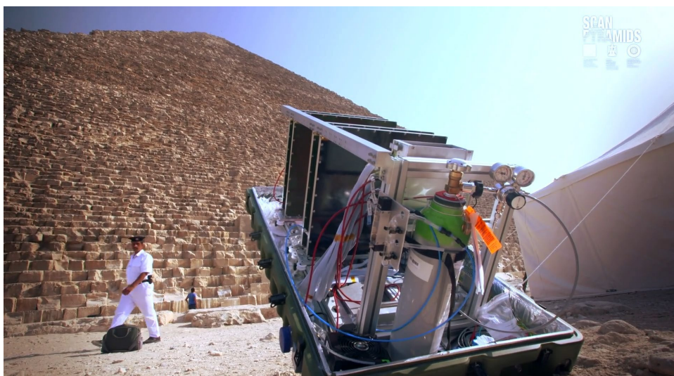
Рис. 7.69 Мюонний телескоп з газорозрядним детектором IRFU CEA, що застосовувався для отримання мюографічних зображень із східного боку Великої піраміди
