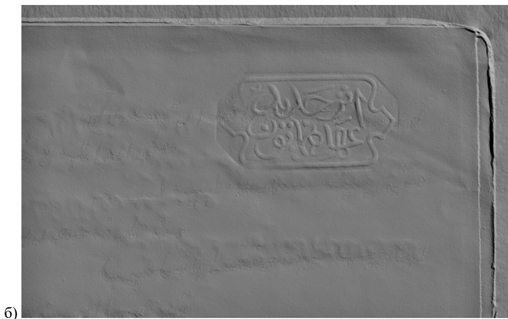
Рис. 7.24. Застосування фотометричної стереосистеми Selene PSS для виявлення водяного знаку у складі рукопису ( https://catalog.princeton.edu/catalog/9963568373506421 ): а) кольорове зображення рукопису у видимому спектрі; б) монохромне зображення
