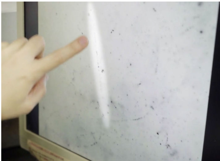
Рис. 7.67 Зображення проєкції руху мюона на екрані комп'ютера в лабораторії Нагойського університету, що фіксується за допомогою ядерної емульсії
